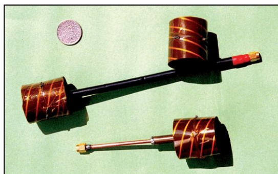
Prototype réalisé en Bande S (2200 MHz)
