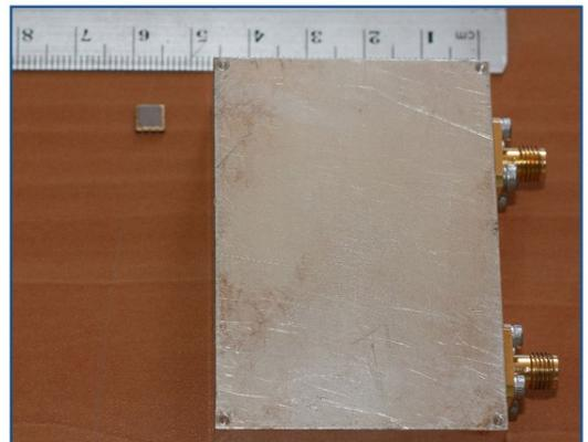
Gain de taille réalisé par le changement de technologie de filtre pour un duplexeur UHF
