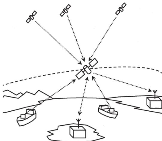
Dispositif de détection des signaux AIS
