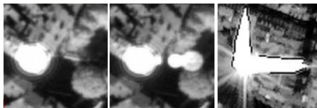
Exemple de phénomènes associés à la présence d'un suréclairement
