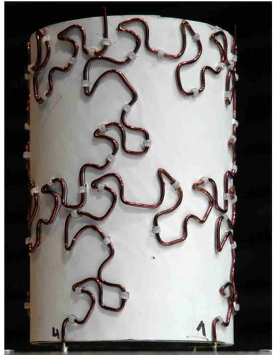
Exemple d'antenne prototype
